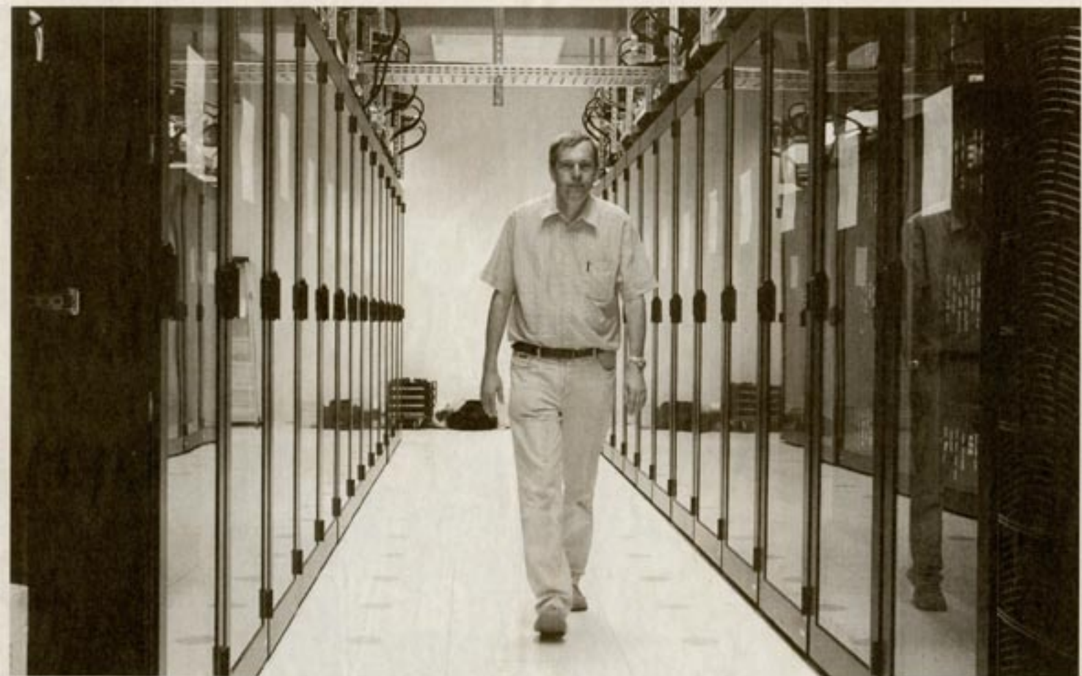
Vizedirektor Dr. Peter Fischer inspiziert die PC-Farm – 26 Spezialschränke gefüllt mit rund 2000 wassergekühlten Opteron-Prozessorkernen von AMD. Das System stammt von Computerhersteller SGI und läuft unter dem Betriebssystem Linux. Fotos (2): Dietrich Flechtner
