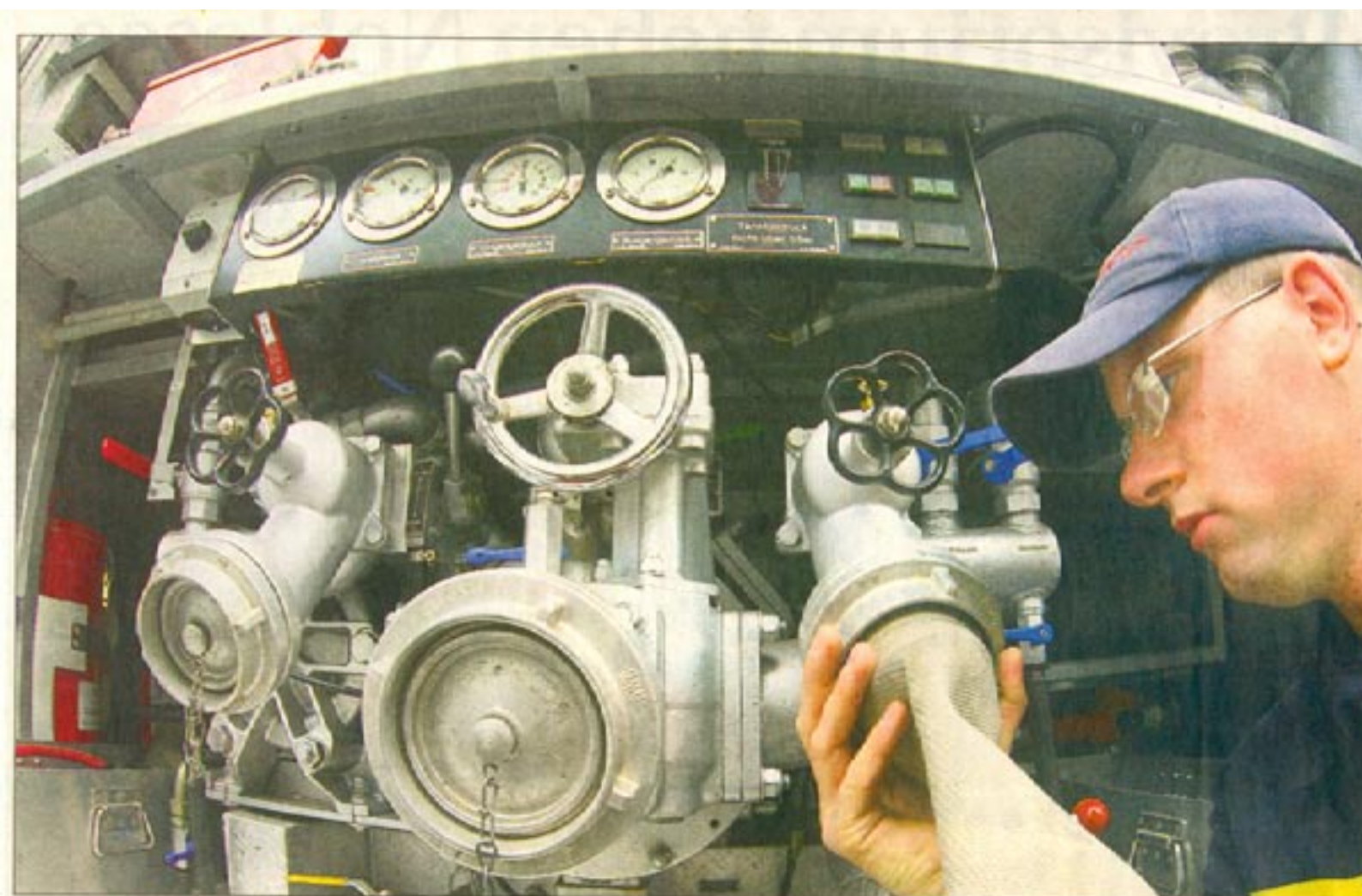
Tausend Mal geübt: Gruppenführer Mario Paul bei der Freiwilligen Feuerwehr Kaitz befestigt den Schlauch am Anschluss des Löschfahrzeugs. Jetzt kann Hahn geöffnet und die Pumpe angestellt werden. In dem Stadtteil machen 27 Männer aktiv mit, und 14 Jugendliche bereiten sich darauf vor. Fotos: Steffen U...
